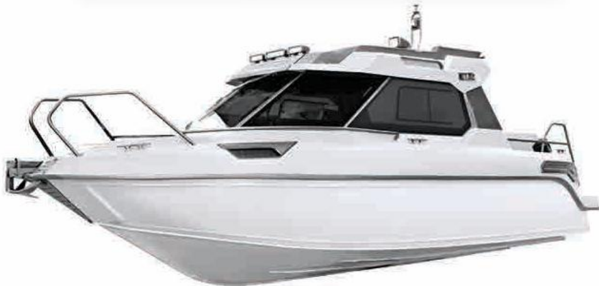
Hình 4.5. Vỏ thuyền làm bằng vật liệu tổng hợp
