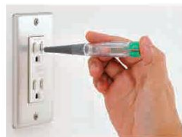
Hình 8.7. Cách sử dụng bút thử điện
