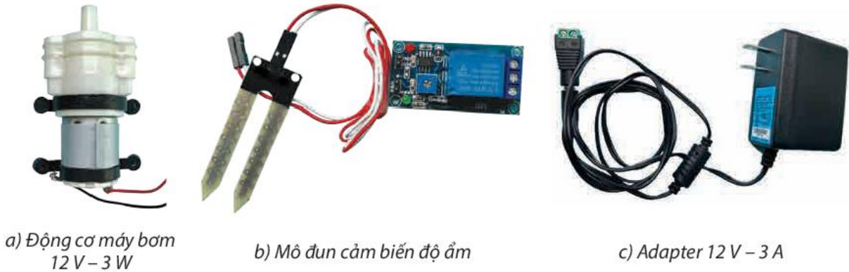
Hình 11.6. Thiết bị, vật liệu chính để lắp ráp mạch điện điều khiển sử dụng mô đun cảm biến độ ẩm
