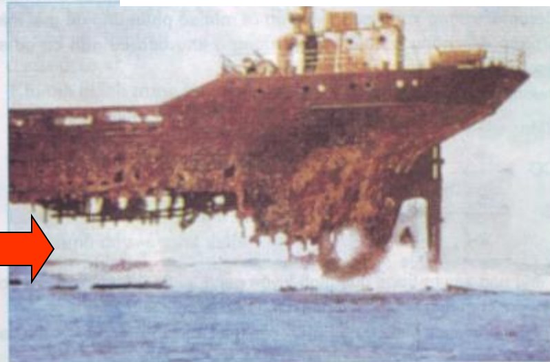
Hình. 2.18. Vỏ tàu thủy bị ăn mòn
