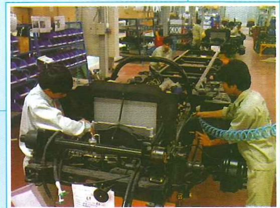
Dây chuyền lắp ráp động cơ và cabin xe tải 3,5 tấn tại công ty Hyundai - TP. Hồ Chí Minh
