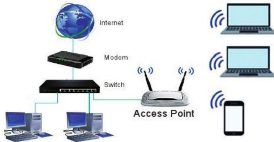
Hình 5. Các máy tính kết nối với Access Point thông qua sóng điện từ
