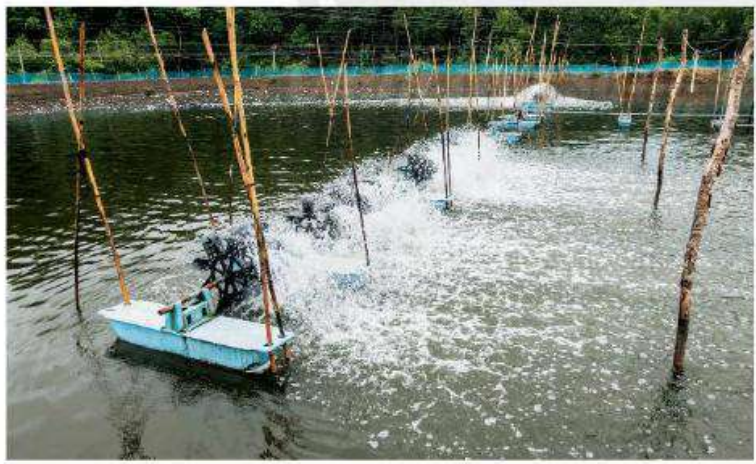
▲ Hình 9.1. Hệ thống quạt khí trong các đầm nuôi tôm
