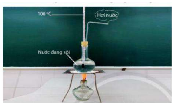
▲ Hình 8.7. Đo nhiệt độ sôi của nước
