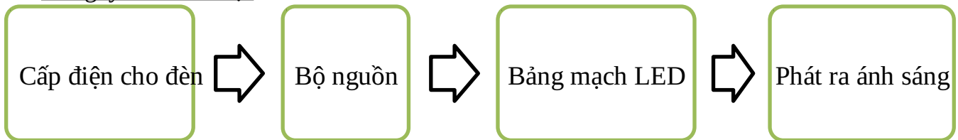
Hình 9.5. Sơ đồ khối mô tả nguyên lí làm việc của đèn LED
