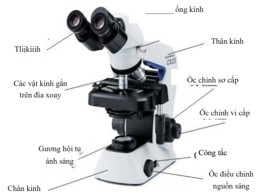
Hình 3.8 Cấu tạo kính hiển vi quang học Plymplus ex 23
